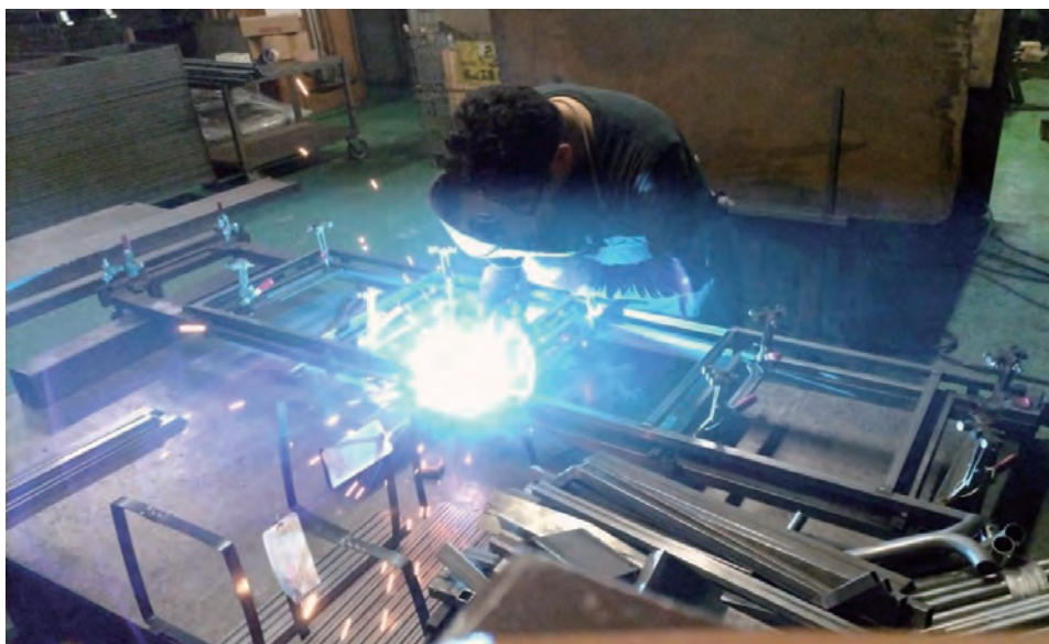
溶接による製作工程
