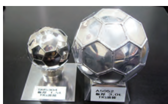
溶接で作したサッカーボール
