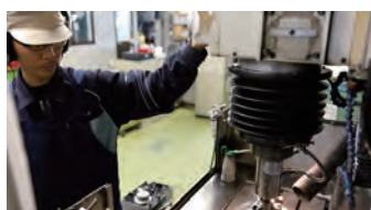
加工精度1μmが可能な治具研削盤
