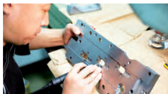
研磨技術が光る手仕上げ加工
