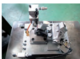
自社設計・内製している油圧治具
