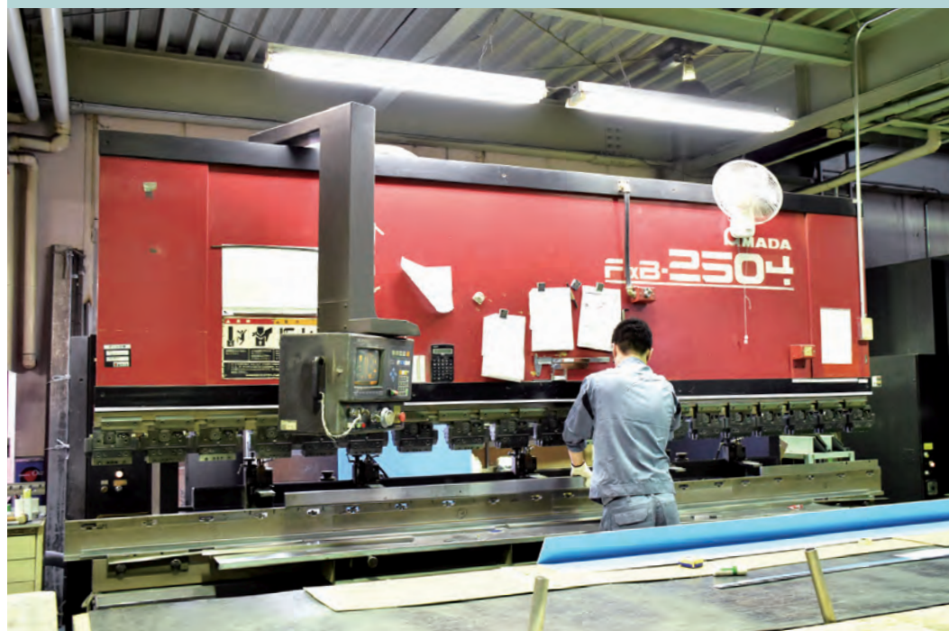
大型曲げ加工機で窓サッシ、ひさし、扉などを加工
