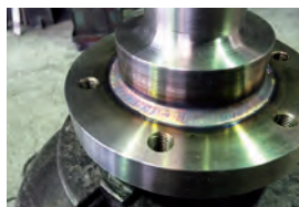
厚板などもTIG溶接で外観を綺麗に溶接
