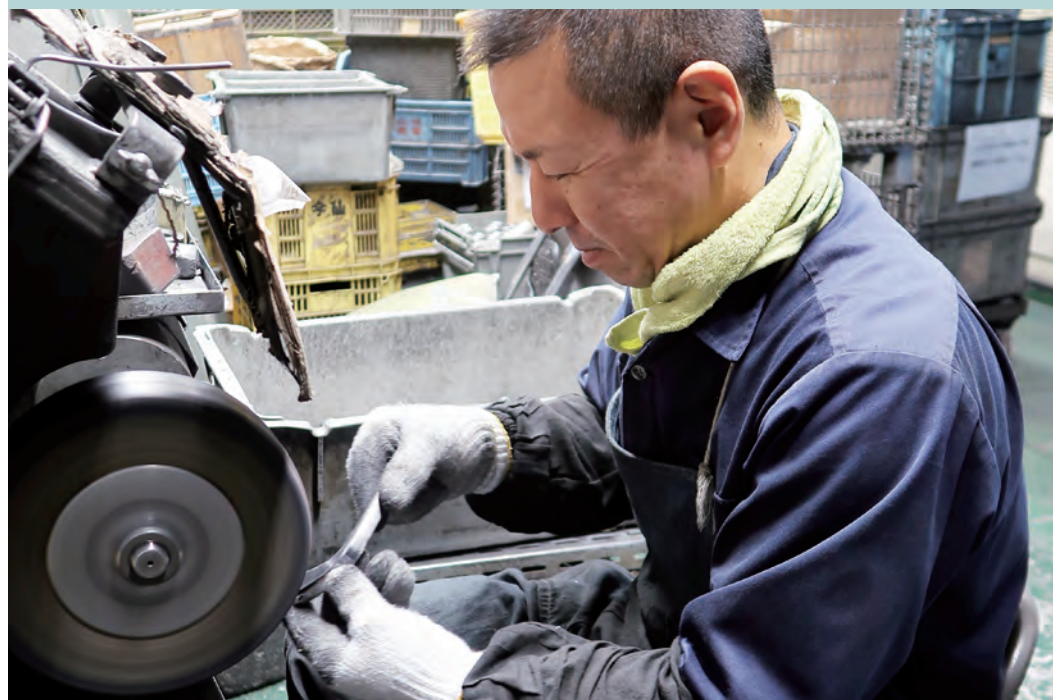
増井義仁代表自らが、バフ研磨職人として金属部品を磨き上げる
