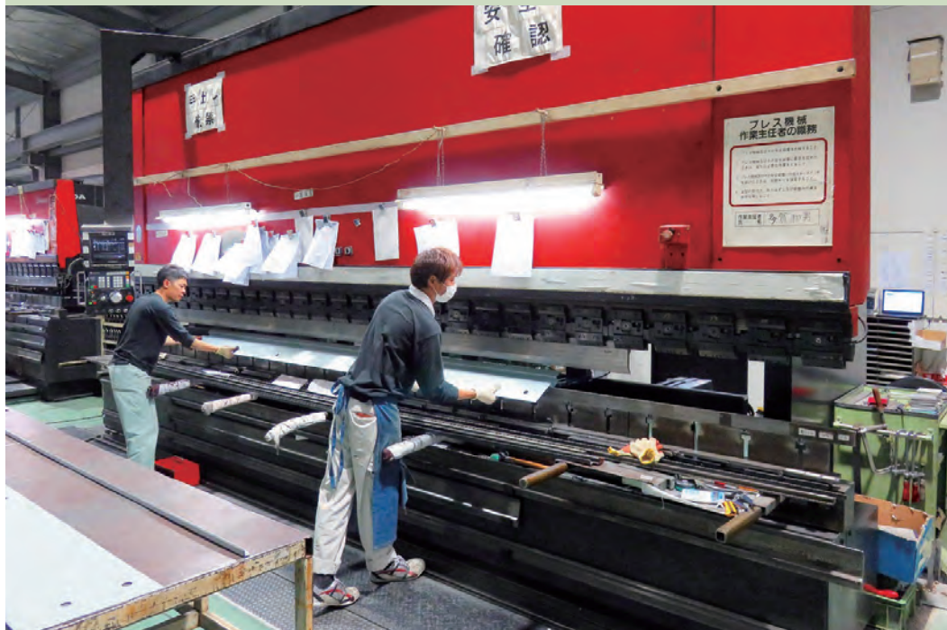
6m曲げ加工機で規格外の特注品に対応
