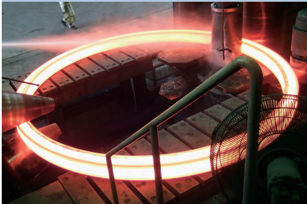
ローリングミルで大型鍛造品を製造
