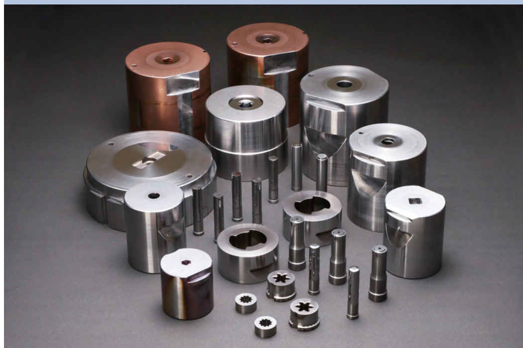
自動車用ナットの鍛造用金型
