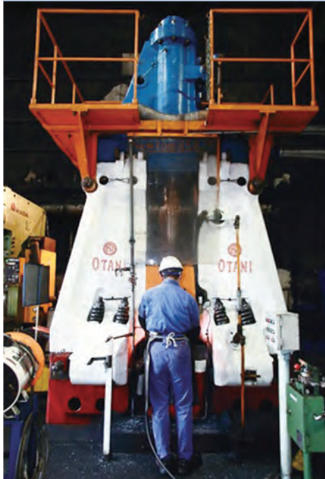
特注エアスタンプハンマー（左）／金型加工（右上）／鍛造の様子（右下）
