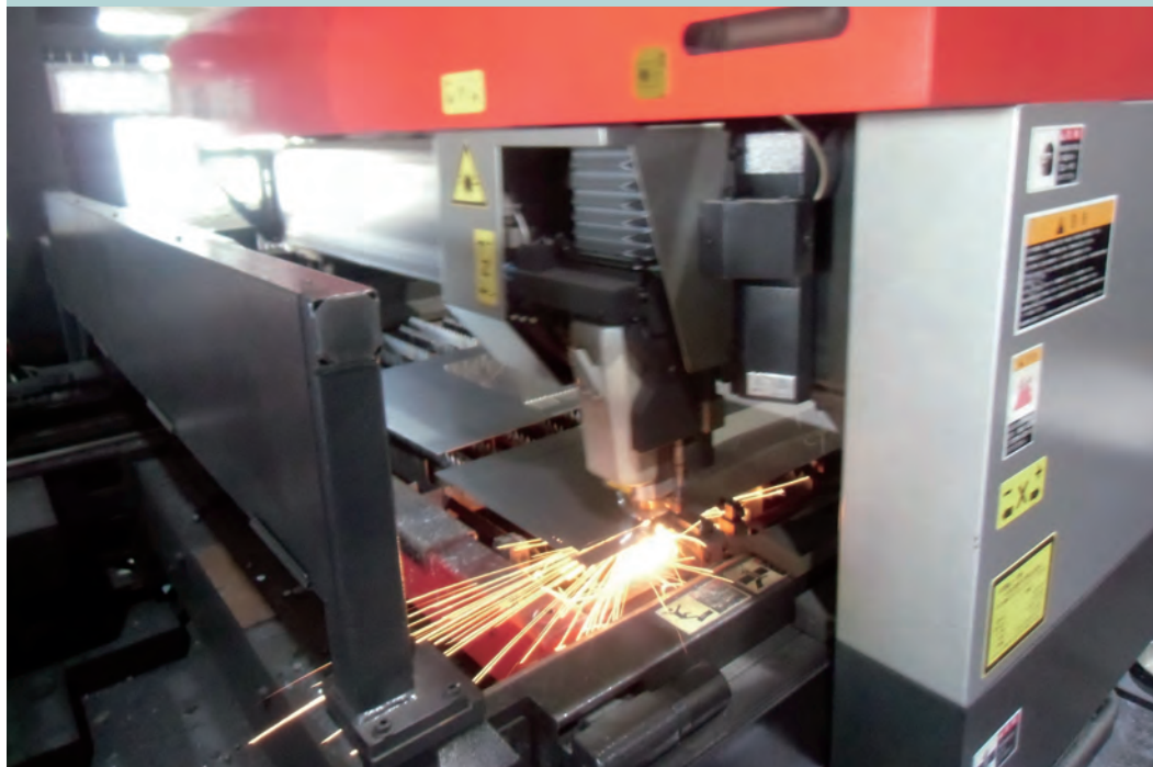
レーザー加工機による作業
