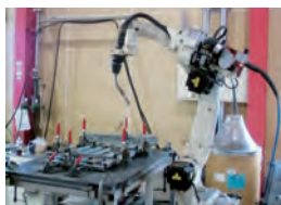
新工場棟に導入した自動溶接機
