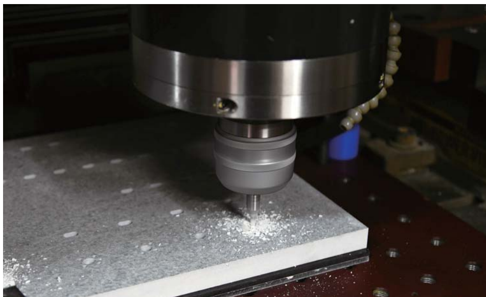
信号配電盤用の端子盤 (材料はTCボード)
