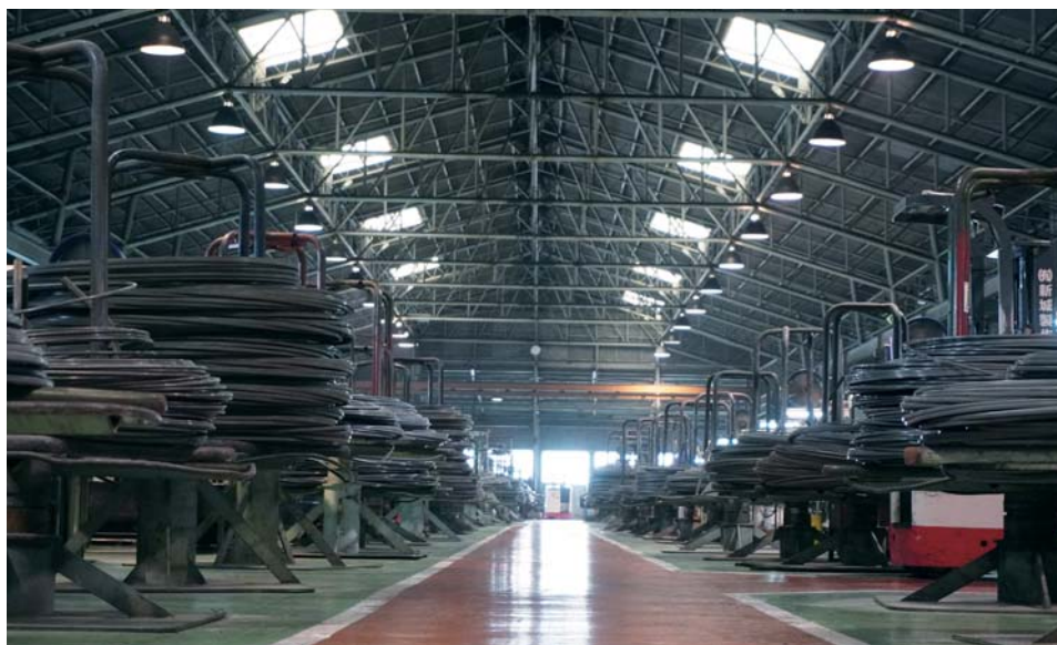
1日500万個のナットを作るナットフォーマー工場
