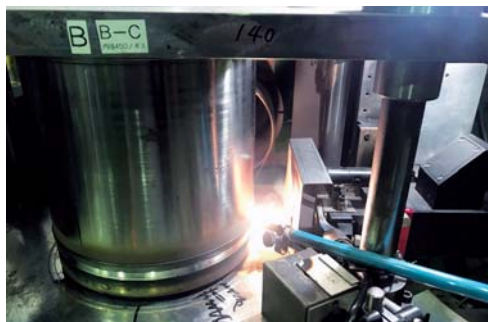
ファイバーレーザー溶接作業
