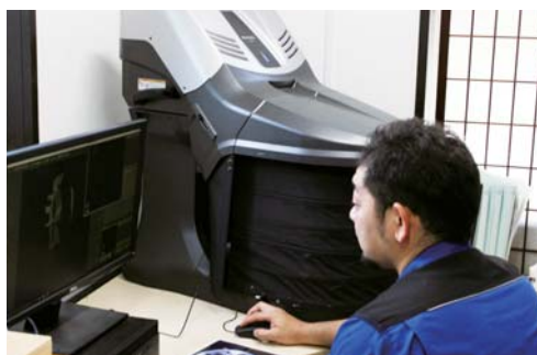
3次元測定機を使って図面を起こす
