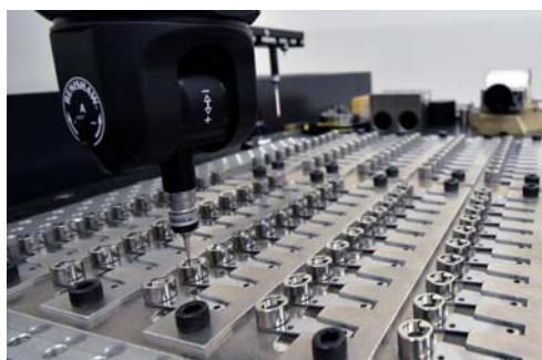
3次元測定機による自動検査
