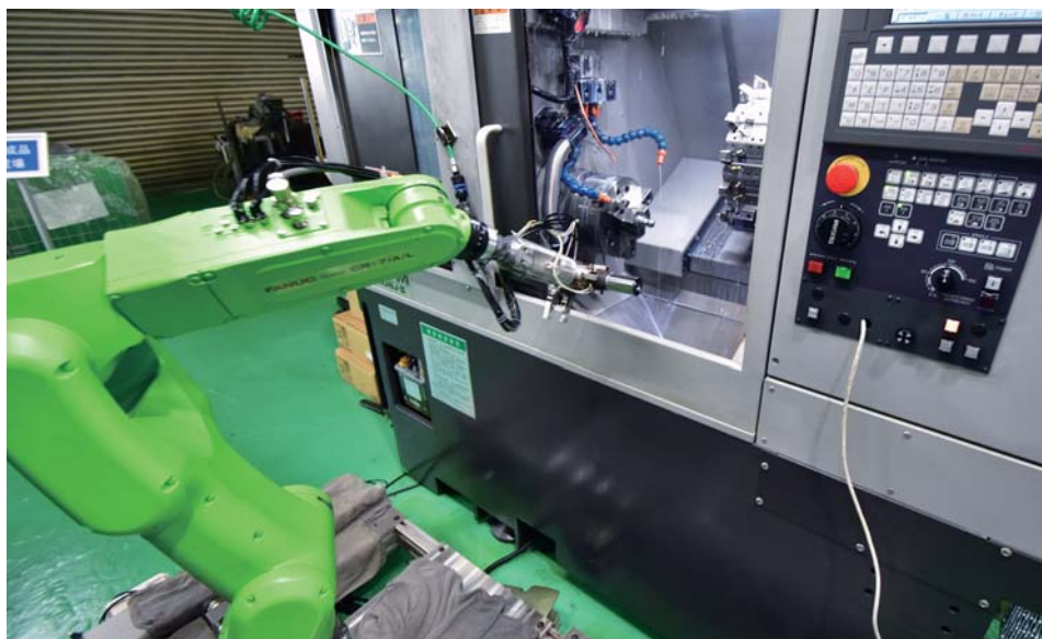
ロボットによる製品取り外し作業
