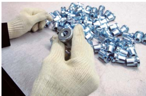
目視での外観検査の様子
