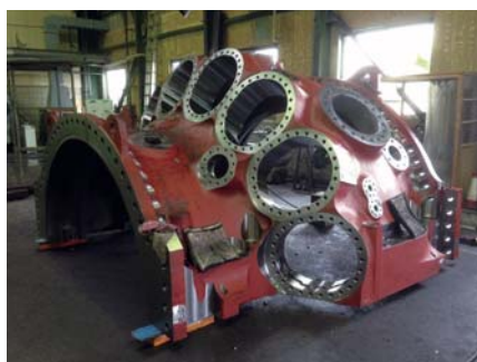
ガスタービンケーシング
