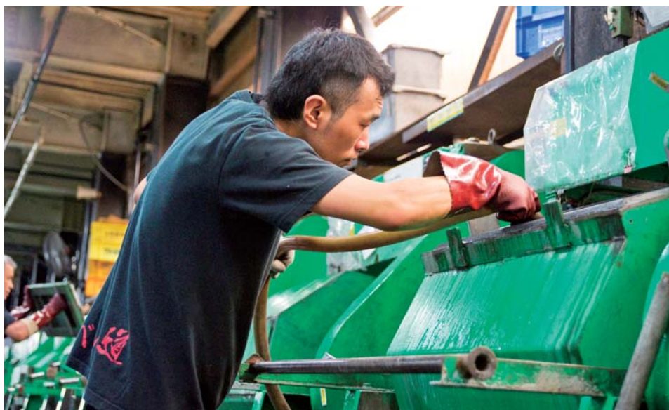
注水による水平回転研磨機の微調整
