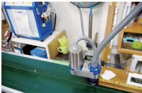
金属やガラスへ強固な密着性を実現するプラズマ加工
