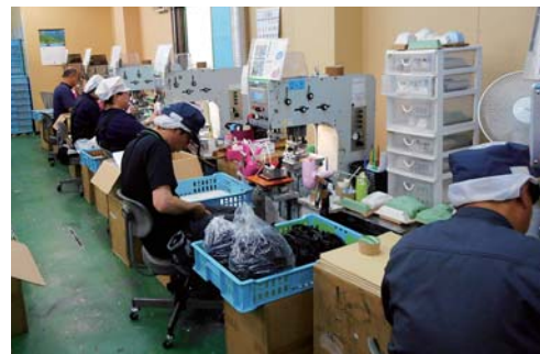
日産20万個を実現する65台のパッド印刷機
