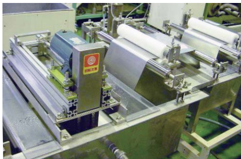
帯鋼洗浄装置のテスト機
