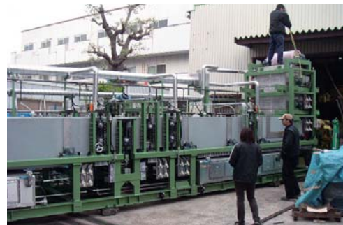
大型の帯鋼洗浄装置の出荷風景
