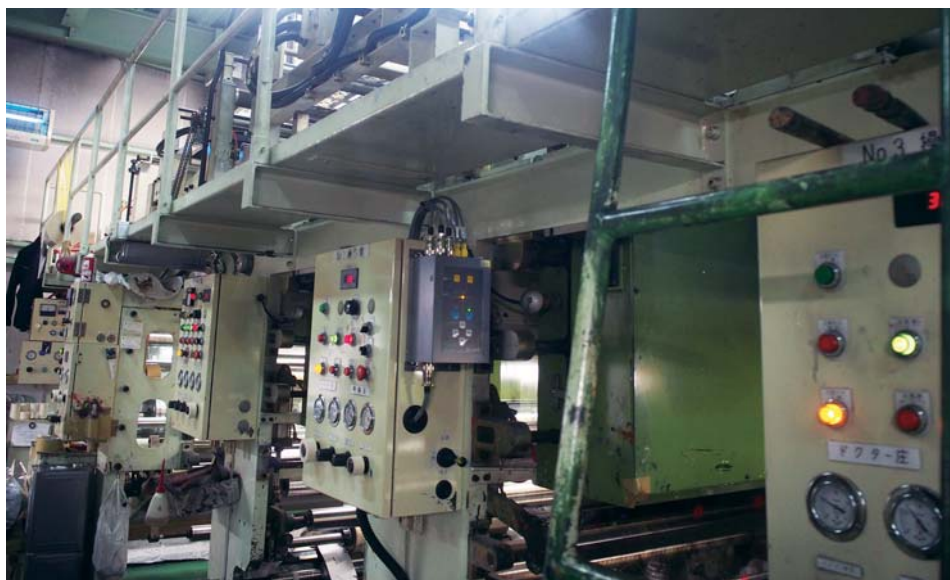
弊工場のグラビア印刷機と自動検知システム
