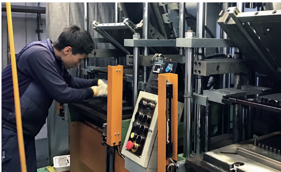
真空成形機で、不良を大幅に削減
