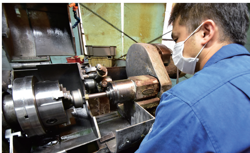
内面研削盤による加工の様子
