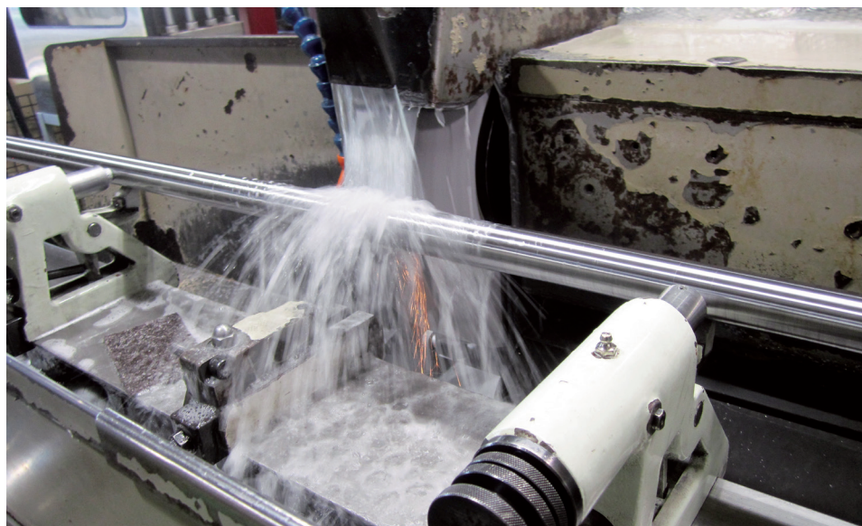
振れ止めを使用して細い長物を研削
