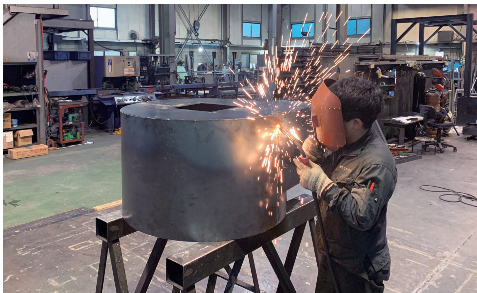
第一工場での溶接作業
