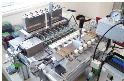
理化学機器向け容器の検査治具
