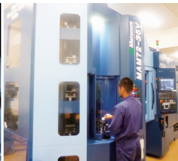
松浦機械製作所製5軸マシニングセンタ(右)と機械内部
