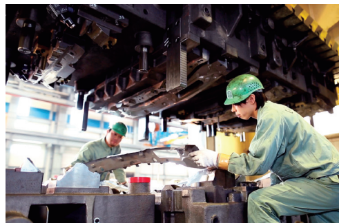
試し打ちで、金型の機能を確認
