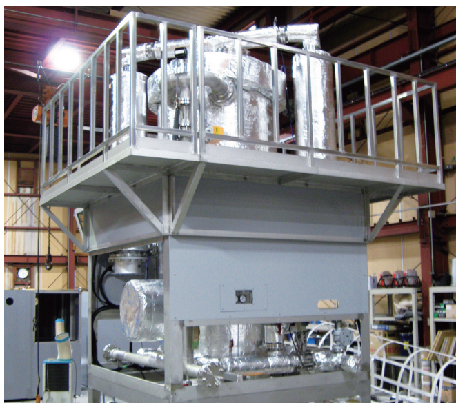
本社工場で製造する浄化処理装置
