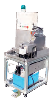
切断したホースの断面(左)と自社開発のホース切断機(右)
