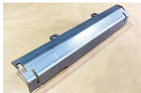
NCブレイキプレスで作成した曲げ製品
