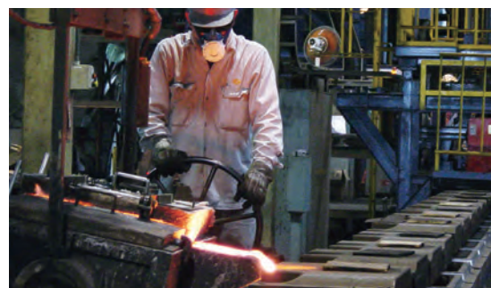
ガラスびん用金型を材料から製作
