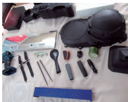
金型表面を加工し、完成した成形品
