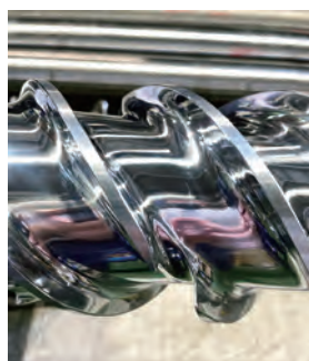
完成した光沢ある長尺スクリー
