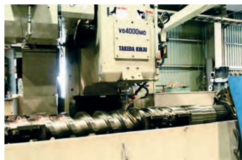
4軸同時制御の螺旋加工が行える
