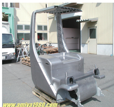
叩き板金の技術を用いて製作したフォークリフトのボディ
