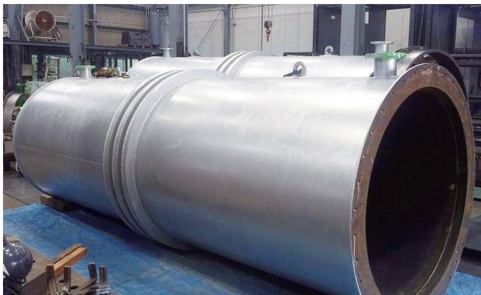
直径2000mmにも及ぶ水冷ダクトの製作にも対応
