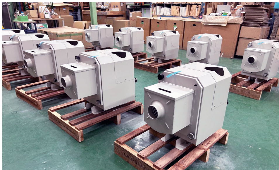
高度な板材加工技術で製作した油煙集塵装置の筐体
