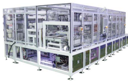
位置精度±50μm(3σ)で貼り付けるフィルム貼付機
