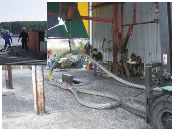
さつま加工で作られる直径120mmのワイヤロープ
