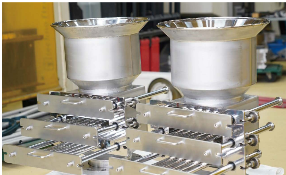
SUS304で製作した磁選機
