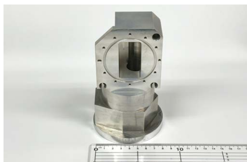
アルミ A5052 の削り出し加工 (2)
