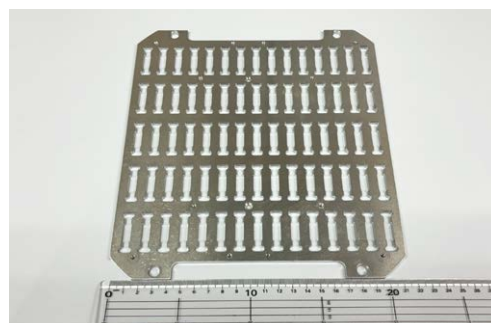
アルミ A5052 の削り出し加工 (1)
