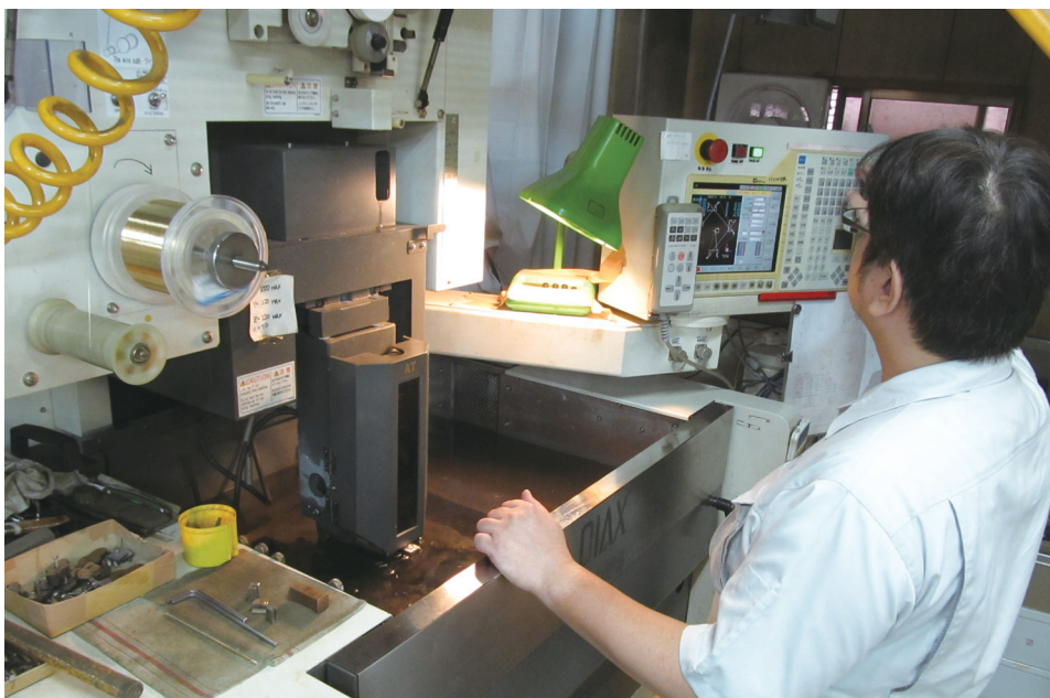
ワイヤーカット機を駆使して金型・部品を加工
