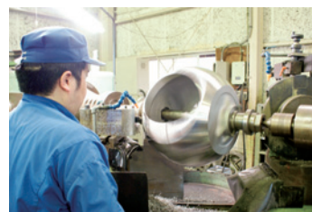
大型球体加工機による研磨加工
