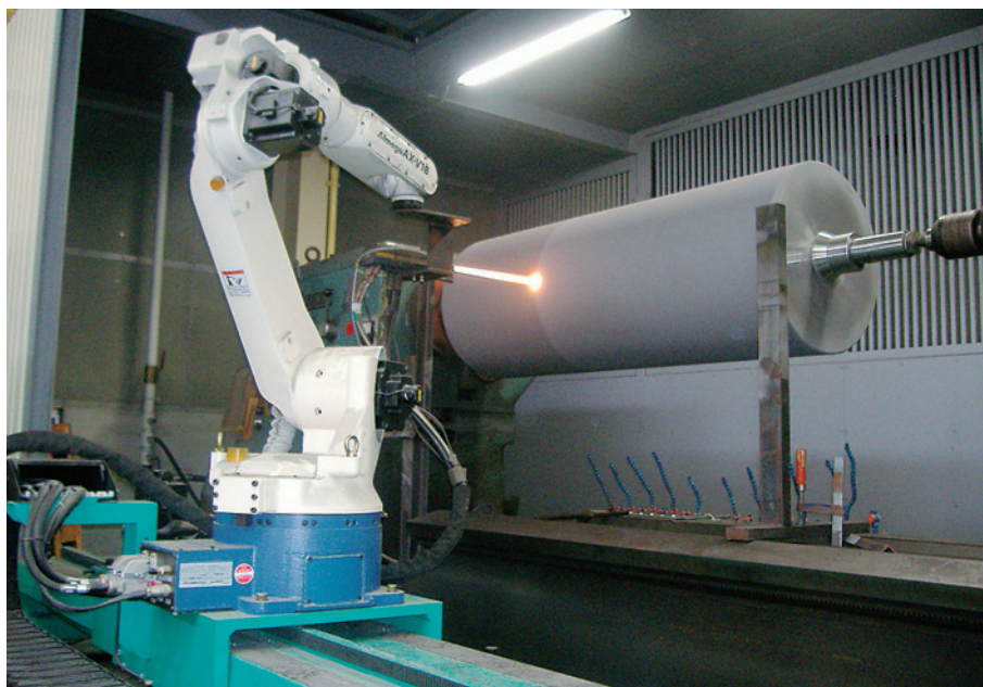
ロール表面への耐摩耗超硬溶射
