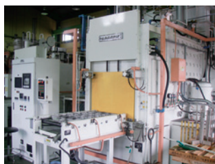
雰囲気制御システム搭載真空浸炭炉
