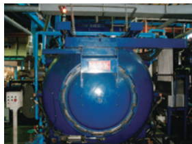
同社保有の真空焼入れ焼戻し炉
