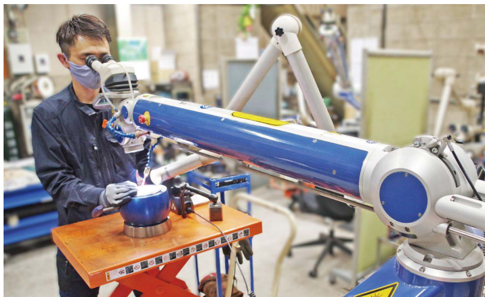
レーザー溶接機 ALM300 による作業
